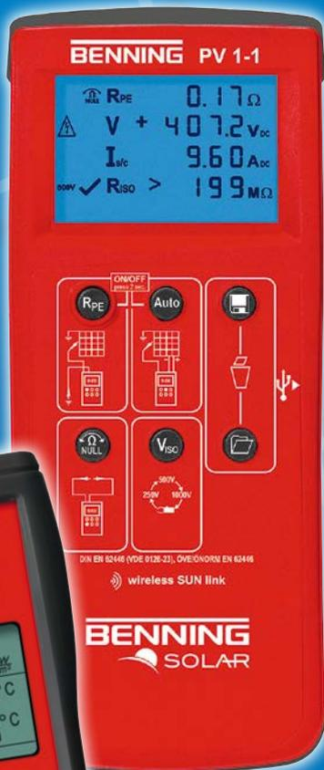
***BENNING PV 1-1 – batteriebetriebener Installationstester für die mobile Prüfung netzgekoppelter Photovoltaik-Systeme***
