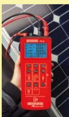
La mesure des connexions (mesure à basse impédance), de la tension en circuit ouvert jusqu'à 1 kV, du courant de court-circuit jusqu'à 15 A DC et de la résistance d'isolement sont les mesures standards pour les systèmes photovoltaïques. L'appareil BENNING PV 2 permet la mesure RISO indépendante et permanente pour la recherche d'erreurs avec des tensions d'essais de 250 V, 500 V et 1000 V DC.
